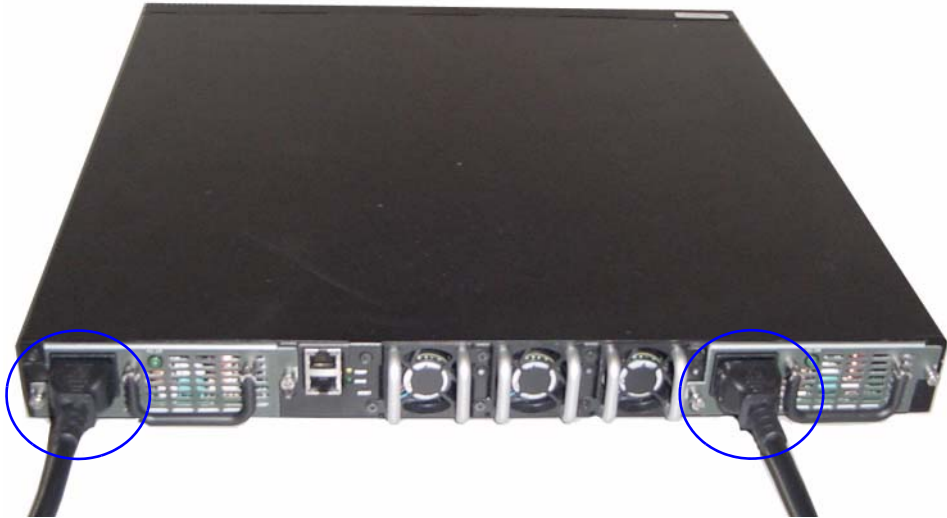
図 2 電源ケーブルの接続
